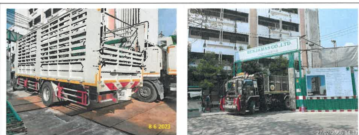
รูปที่ 2-44 แสดงการติดแผ่นป้ายสะท้อนแสงบริเวณด้านท้ายรถ และธงสีบริเวณด้านข้างทั้ง 2 ข้าง ของรถขนส่งดินและวัสดุก่อสร้าง
