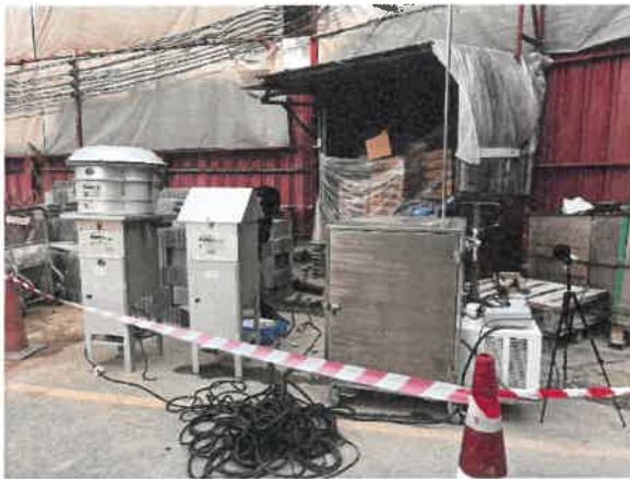
รูปที่ 2-23 แสดงการติดตั้งเครื่องตรวจวัดคุณภาพอากาศ เสียง และความสั่นสะเทือนไว้ในพื้นที่ก่อสร้าง และพื้นที่วิทยาลัยแพทยศาสตร์
